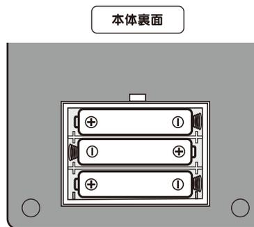
本体裏面にある電池ボックスのカバーをスライドして開けます。
