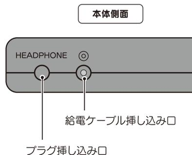
本体側面にある給電ケーブル挿し込み口に付属の給電ケーブルを挿し込みます。
