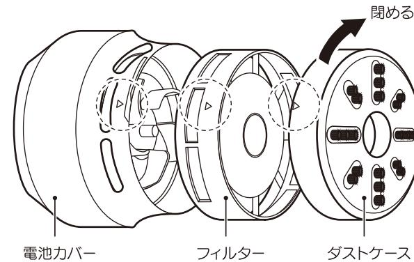
お手入れ後、フィルターを取り付ける際は本体とフィルターの▼印を合わせて取り付けてください。
