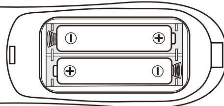
本体側面の電池カバーを開け、単3電池×2本(別売)を正しくセットしてください。
