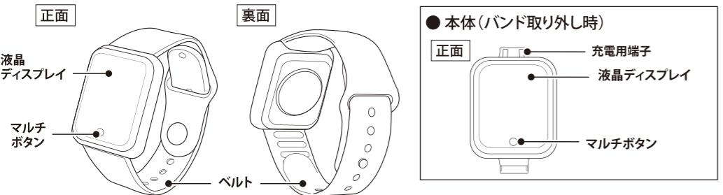
バンド取り付け・取り外し方法 ※取り付け・取り外す際に本体に力を加えます。破損や怪我にお気をつけください。
