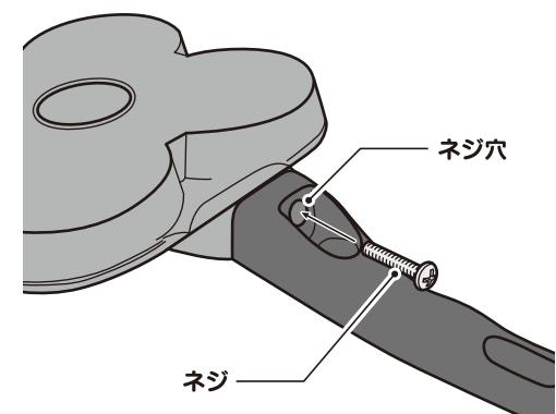
②付属のネジを、取っ手の裏側のネジ穴に取り付け、
