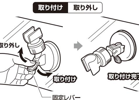
取り付ける際は壁に吸盤を押し付けながら、取り付け方向に固定レバーを下げてロックします。
