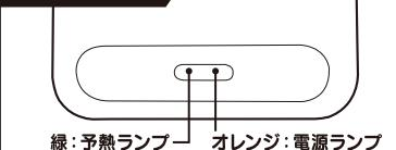
※予熱ランプはプレートが十分に温まると自動で消灯しますが、加熱は継続されます。
