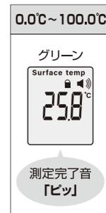
※マルチ測定モードの温度測定範囲(0.0°C~100.0°C)を超えるとアラート音が鳴ります。ディスプレイにHi/Loが表示され、測定範囲を超えたことをお知らせします。
