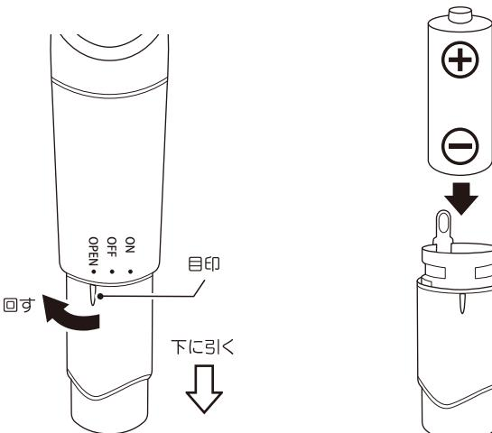
①本体の電池ボックスを矢印方向に回して目印をOPENに合わせ、下に引きます。
