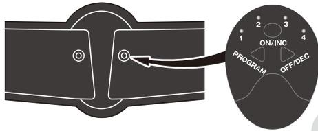
※取り付けの際は、バッテリー側のスナップ部分の近くを押すようにしてください。破損するおそれがあります。
